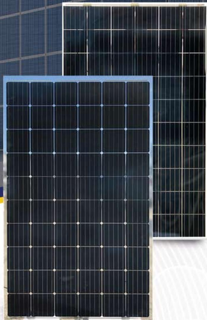
Стекланные солнечные батареи **SILA (Double Glass)** состоят из высококачественных ячеек поликристаллического или монокристаллического кремния, вплавленных между двух листов закаленного стекла без использования полимерного заднего слоя. Это позволяет модулю пропускать часть солнечного света внутрь помещения в течение дня, но при этом еще и генерировать электроэнергию.
