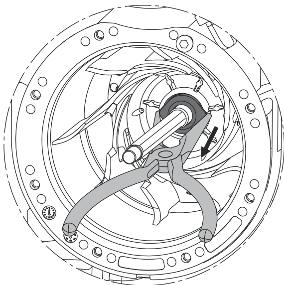
Рис. 11 Снятие неподвижного кольца торцевого уплотнения вала
