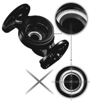
15-сур. Тығыздаудың қате теңестірілген жүйесі
