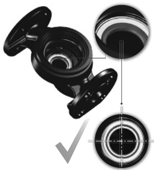
Рис. 14 Правильно выровненная система уплотнений
