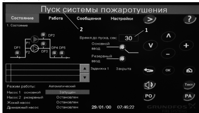
Рис. 12 Меню «Состояние» при поступлении сигнала на запуск
