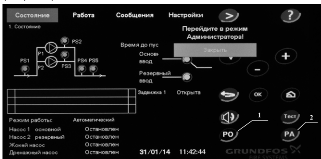
Рис. 8 Экран панели оператора после нажатии кнопки «РА»
