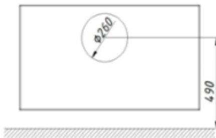
Рисунок 4: Монтаж конвекторов к стене
