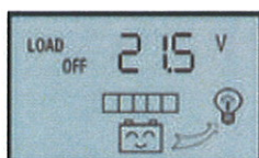
7. Отключение нагрузки при разряде аккумулятора (программируемый параметр) (LVD)
